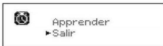
3. Para salir de la función, seleccionar **Salir** con los pulsadores ↑ ↓ y presionar **OK** para confirmar.
